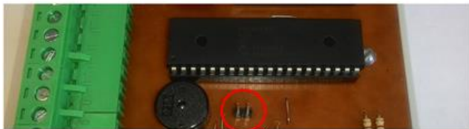
Установка (снятие) джампера Джампер снят
